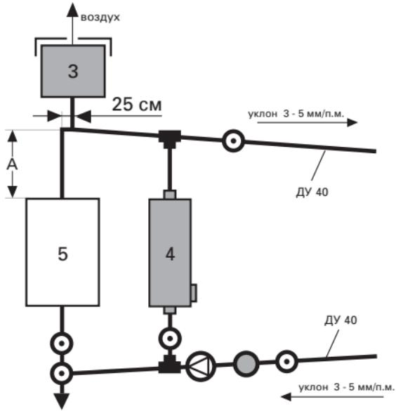
Рис. 2 Схема параллельного подключения резервного котла
