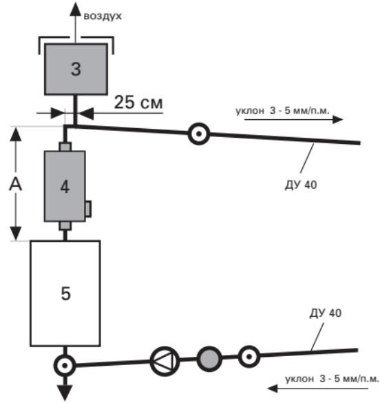
Рис. 3 Схема последовательного подключения резервного котла
